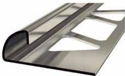
**PROFIL J.** Profil incurvé spécialement conçu pour la protection et la décoration des coins extérieurs sur les surfaces en céramique et les bords extérieurs des sols carrelés, des marches et des plates-formes... Sa courbure offre une finition symétrique et sûre autour du coin, évitant les bords tranchants. Il n'est pas nécessaire d'ongler les tuiles, en évitant les ruptures, surtout dans les zones avec beaucoup de passage.
