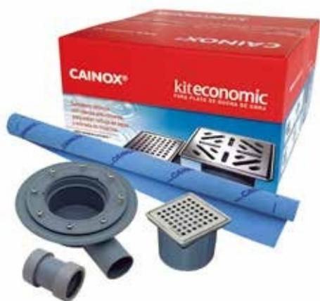
Kit pour bac à douche composé d'un cadre, d'une grille perforée au design original et de vis en acier inoxydable AISI304. Le corps siphonique en polypropylène est entièrement amovible et comprend une clapet anti-retour, une bride de serrage pour le tissu d'étanchéité SKY, également inclus et un manchon de joint en PVC. La partie supérieure cylindrique peut être facilement coupée pour ajuster la hauteur à la chaussée finale, selon les besoins de l'installation. Débit d'évacuation: 0,5 l/s.
