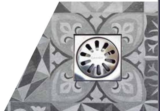
Drains carrés entièrement en acier inoxydable AISI304, avec une finition polie miroir. Il intègre un siphon intégré et une grille perforée. Disponible en prises horizontales et verticales. Débit d'évacuation: 0,7 l/s.
